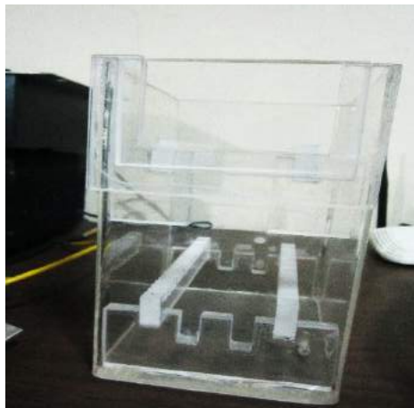
Figura 21. Construcción de reactor para electrocoagulación Fuente: (Yagual Romero, 2017)
