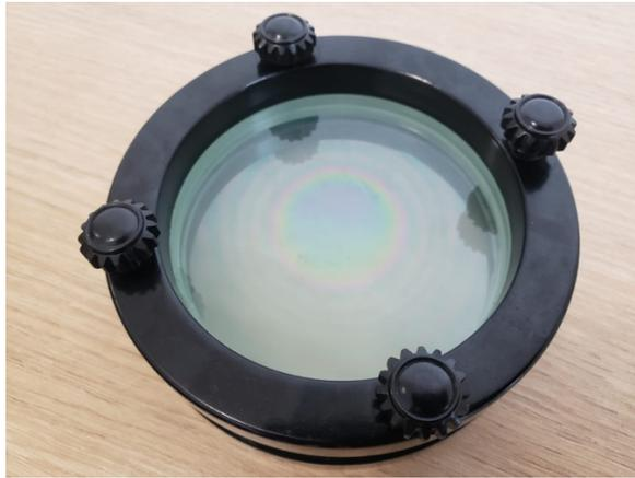
**Figura 6.9** Anillos de Newton provocada por luz policromática
