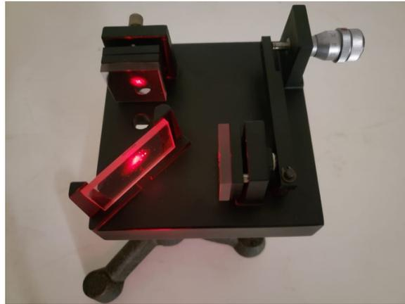
**Figura 6.11** Interferómetro de Michelson
