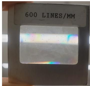
Cuando la luz incide sobre una red plana de difracción, parte de ella es reflejada y parte es transmitida a través de las ranuras. Recordemos que de acuerdo al principio de Huygens cada ranura actuará como una fuente puntual de ondas secundarias que producen un patrón de interferencia.
