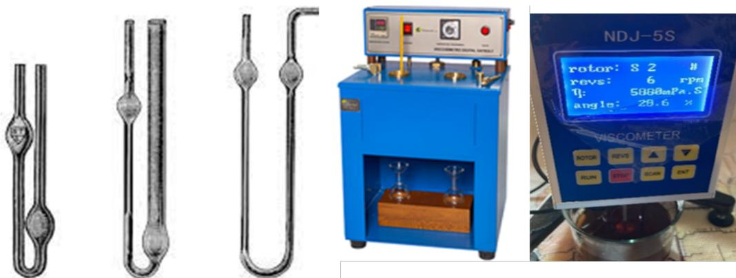
Figura 1.4. viscosímetros de Ostwald, Saybolt y rotacional
