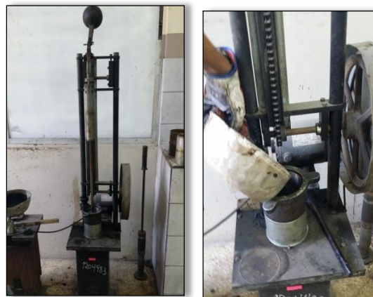
Figura 3-11: Compactación de briquetas
