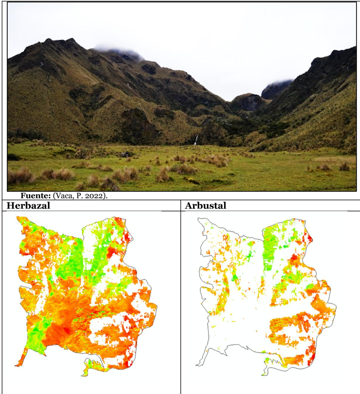
Cuya formula es  $EVI = 2.5 * (NIR - RED) / (NIR + 6.0 * RED - 7.5 * BLUE + 1.0)$ , donde NIR es la Espectroscopía de Reflectancia en el Infrarrojo Cercano y RED es Espectroscopía de Reflectancia de la parte Roja Visible Y BLUE Espectroscopía de Reflectancia de la parte Azul Visible (Shen et al., 2010. pp. )
