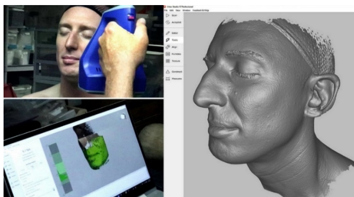
Figura 21. Técnica de escaneo mediante luz estructurada
