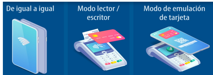
Figura 17. Modos de transferencia NFC
