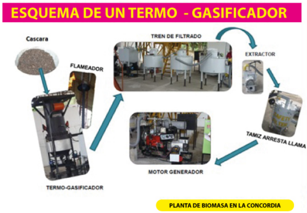
Figura 6.11: Esquema de una planta de termogasificación
