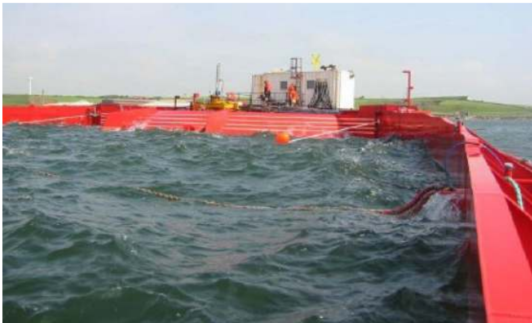
Figura 7.8: Sistema off-shore flotantes WAVE DRAGON SYSTEM
