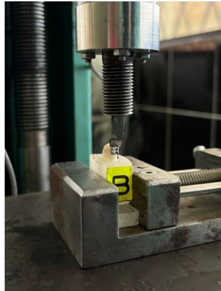
Figura 7: Fijación y estabilización de la base de acrílico con la máquina de estudios y posición de la punta biselada de acero inoxidable.
