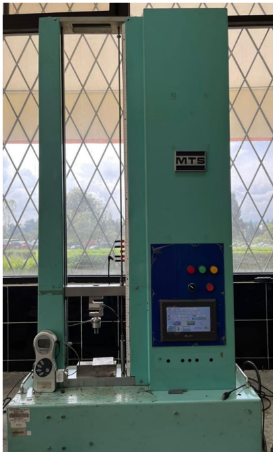
Figura 6: Máquina de ensayos universal de marca MTS, Modelo T5002.
