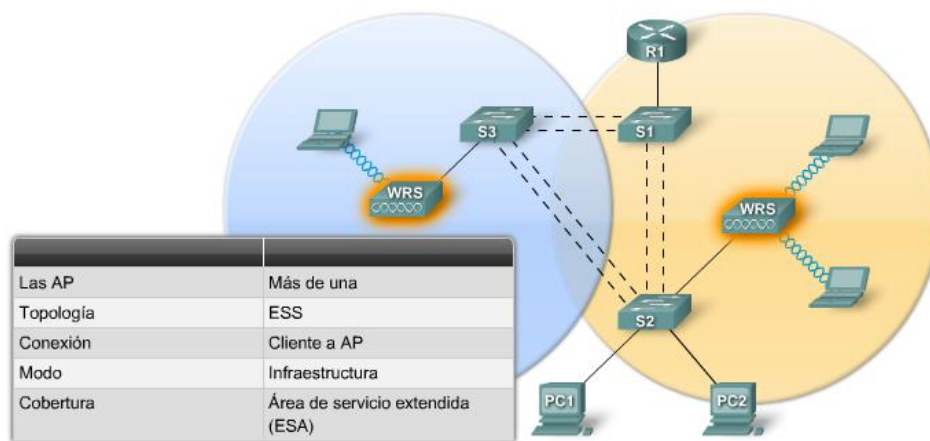
Figura 4.5 ESS (Conjunto de servicios extendidos mediante áreas de cobertura extendida por medio de BSSID) Creada por: Francisco Palacios.
