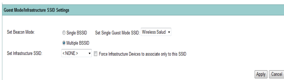
Figura 4.64: Difusión de Múltiples SSID Creada por: Francisco Palacios.
