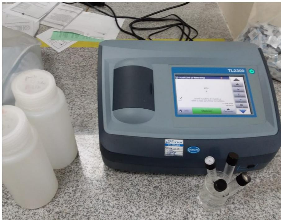
Figura22.Determinación de Turbidez, en laboratorio.
