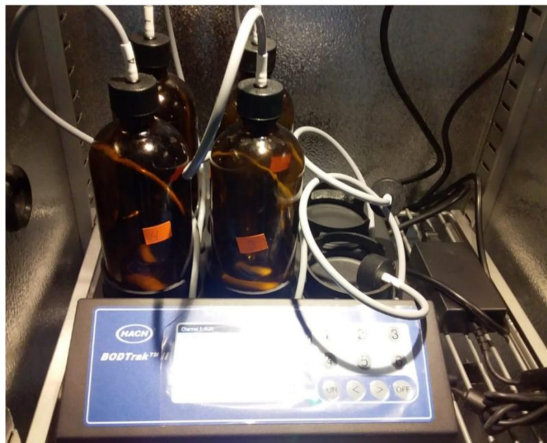
Figura 20. Determinación del  $DBO_5$  en laboratorio.
