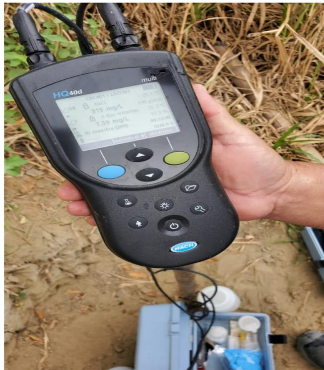
Figura 18. Determinación de Oxígeno Disuelto, Sólidos Totales Disueltos, Temperatura, en situ.
