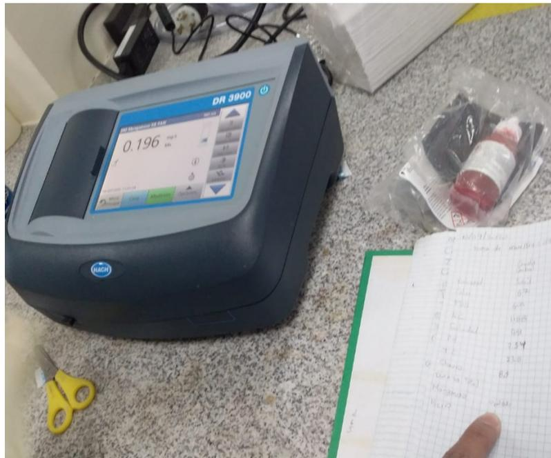
Figura 19. Determinación de Nitratos y Fosfatos en laboratorio.
