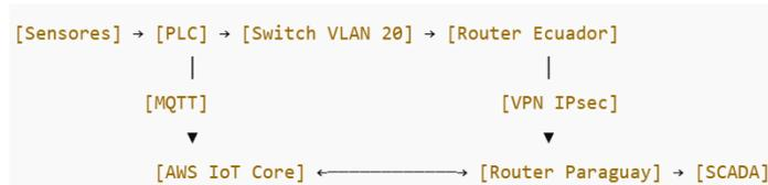
En la figura 51 se muestra el esquema de la VLAN entre dos países con envío de datos por un proceso industrial
