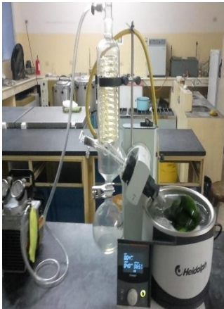
Foto 1.9 Recuperación de solvente (metanol; agua acidulada) y obtención de sustrato del proceso de lixiviación (aceite).
