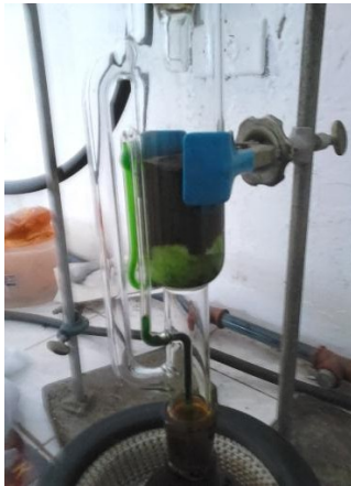
Foto 1.8 Lixiviación de muestra seca con solvente (metanol; agua acidulada).
