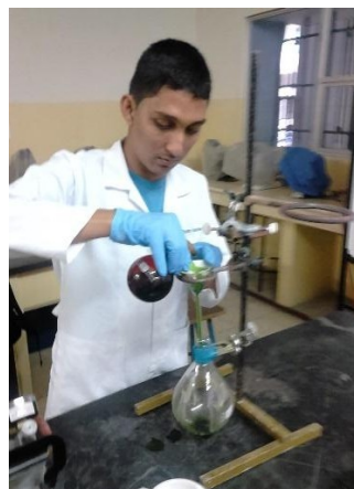
Foto 1.8 Filtración de extractos con solvente (agua acidulada; metanol).
