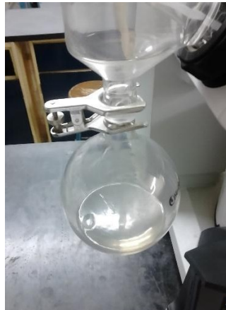
Foto 1.9 Recuperación de solvente (metanol; agua acidulada) y obtención de sustrato del proceso de lixiviación (aceite).
