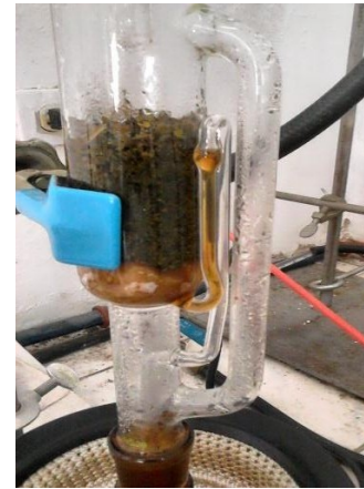
Foto 1.8 Lixiviación de muestra seca con solvente (metanol; agua acidulada).
