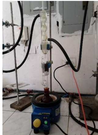
Foto 1.8 Lixiviación de muestra seca con solvente (metanol; agua acidulada).
