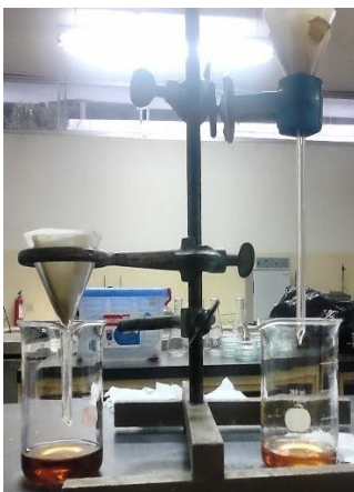
Foto 1.8 Filtración de extractos con solvente (agua acidulada; metanol).
