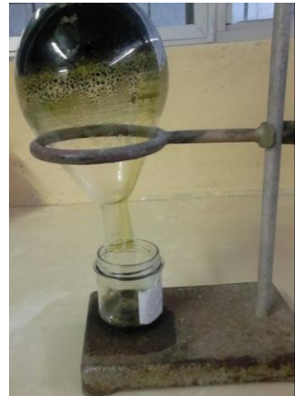
Foto 1.9 Recuperación de solvente (metanol; agua acidulada) y obtención de sustrato del proceso de lixiviación (aceite).
