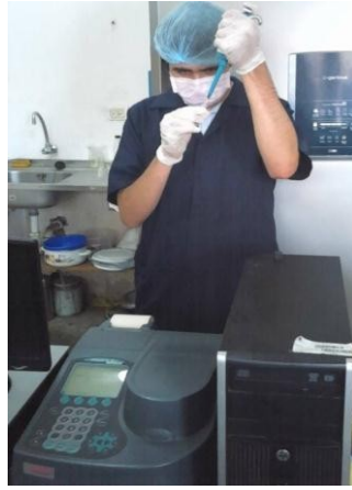
Adición de muestra a la cubeta espectrofotométrica
