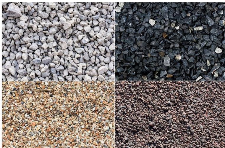
Figura 7. Gravas para subdrenes
