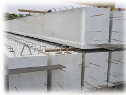
Figura 19: Vigas de hormigón pretensado
