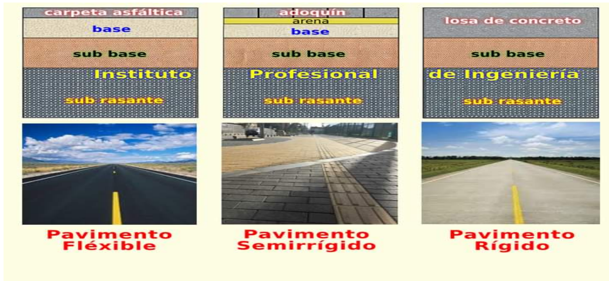
Figura 1. Estructuras de pavimentos flexible, semirrígido y rígido.
