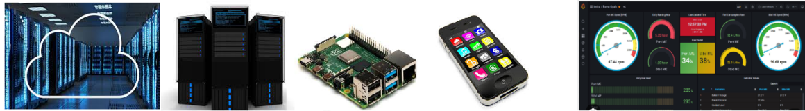
Figura 1.23 Capa de aplicaciones, encontramos tanto plataformas de hardware como aplicaciones, de izquierda a derecha tenemos: servidores en la nube, servidores, locales, plataformas de bajo recursos como RPi, teléfonos inteligentes y el dashboard Grafana. Elaboración propia
