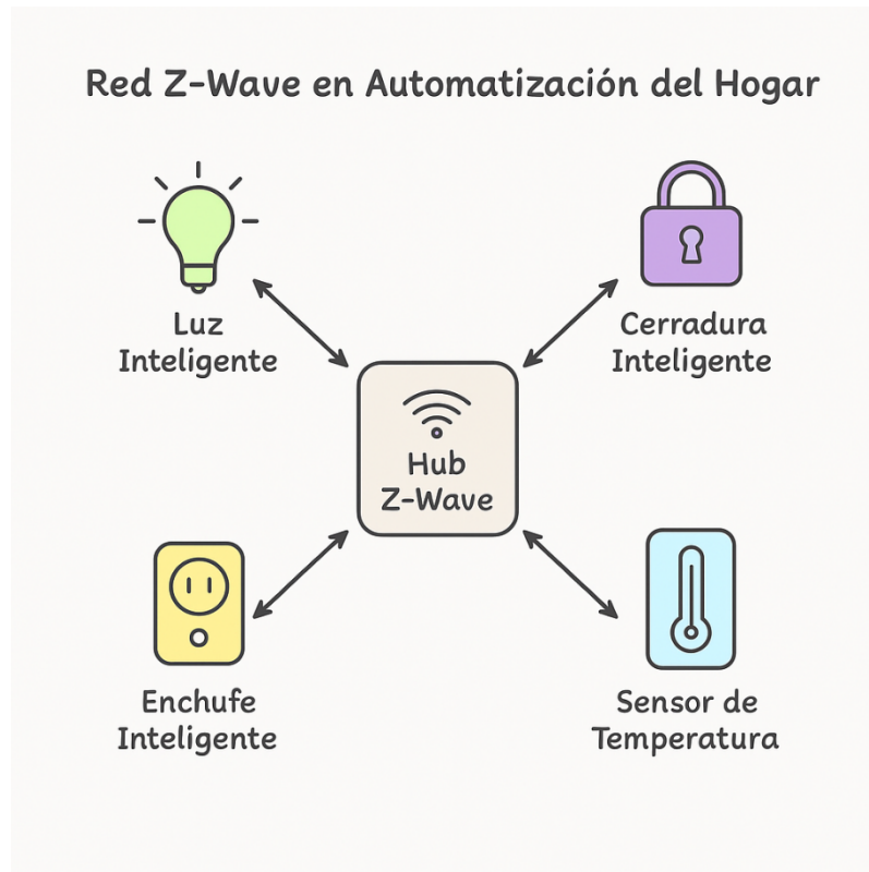
Figura 1.37 Arquitectura de una red Z-Wave para automatización del hogar. Elaboración propia.
