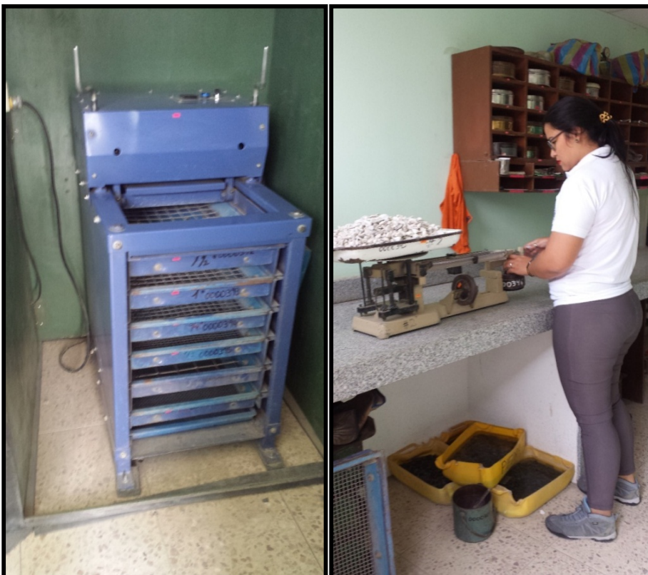
Ilustración 2 Máquina para Ensayo de Granulometría
