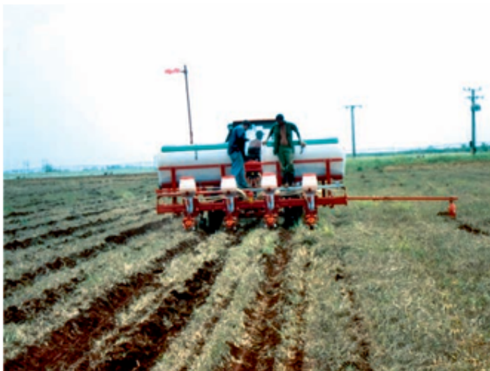
Figura 1.18. Sembradora de maíz marca Regina, en plena labor de siembra. Nótese las características del terreno. Fuente. González et al. (2013).
