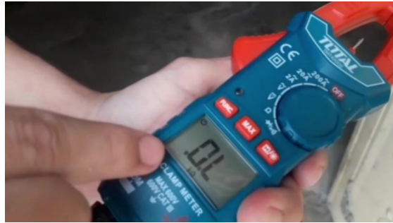
Ilustración 2.9 Medición errónea de corriente alterna (Elaboración propia)
