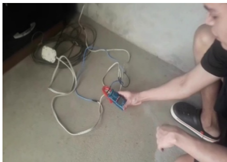
Ilustración 2.10 Medición de la corriente de cada equipo (Elaboración propia)
