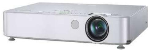
Un proyector LCD funciona haciendo pasar una potente fuente de luz a través de una matriz LCD transparente, con una serie de píxeles que representan la imagen. Esta imagen es proyectada a través de una lente en una pantalla grande. Simplificándolo mucho, en cierto modo se parece a un proyector de diapositivas, pero en vez de éstas, hay una pantalla LCD transparente.
