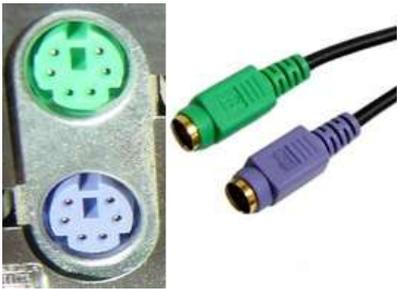
Conector PS/2 correspondiente al teclado. Como se observa, es exactamente igual al del ratón, algo que puede provocar confusiones a la hora de la conexión. No obstante, no se preocupe ya que no se dañara ningún componente de su PC. Al comprobar el error puede colocarlos en su posición correcta sin ningún tipo de problema.
