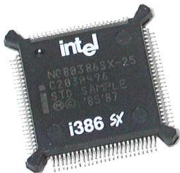
En 1985, Intel presentó el 80386, un micro de 32 bits que integraba 275000 transistores y tenía una potencia de cálculo de 5 MIPS. Esta vez, sin embargo no fue IBM la primera compañía que lo incorporó a sus nuevas computadoras, sino Compaq en su modelo Deskpro 386.
