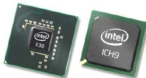
Otra de las funciones de las que se encarga el chipset es la transferencia de datos entre el procesador y la memoria. También determina la cantidad máxima de memoria RAM que se puede poner al computador, la velocidad del bus del sistema, la posibilidad de poder utilizar puertos de alta velocidad (AGP, PCI-Express), etc.
