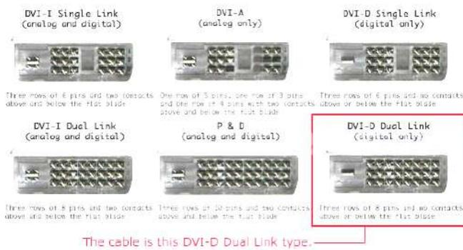
Conector DVI o Digital video Interface (interfaz de video Digital) tiene como principal característica el modo de señal digital en lugar de analógica (algo que repercute de forma directa en un aumento de velocidad al evita conversiones digital-analógico). Este conector, definido por el consorcio DDWG (Digital Display Working Group),
