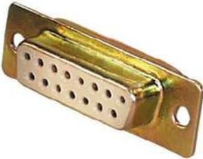
Conector multifunción hembra de 15 pines dividido en dos filas de ocho y siete pines. Así, se trata de un puerto analógico para la conexión de joysticks para juegos. Por otro lado, se usa también como conector MIDI para instrumentos digitales. Siempre va asociado a una tarjeta de sonido aunque hubo un tiempo en el que se encontraba con las controladoras de disco.
