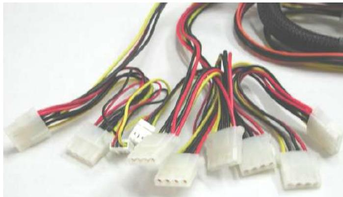
Cualquier dispositivo de almacenamiento conectado al computador dispone de dos cables de conexión: uno que lleva a la corriente eléctrica (y que va enganchado a la fuente de alimentación) y otro conocido como cable de bus de datos que se encarga de transmitir la información desde el dispositivo hasta el procesador y viceversa.
