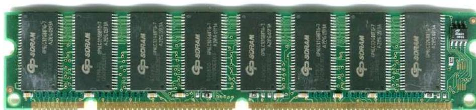
Inicialmente los módulos de SDRAM funcionaban a 100 MHz, y posteriormente, lo hicieron a 133 MHz. Aunque los computadores que soportaban módulos de 133 MHz también permitían instalar módulos de 100 MHz, no era recomendable mezclar módulos de ambas velocidades en un
