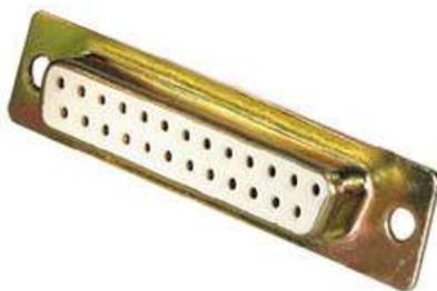
Puerto paralelo. Se trata de un conector de 25 pines hembra distribuido en dos filas de 13 y 12 pines respectivamente. Su misión, al igual que la del resto de los puertos, es la de permitir una comunicación paralelo de 1 byte. No obstante, su aplicación más convencional es el manejo de impresoras y, ocasionalmente, escáneres y otro tipo de unidades externas donde el puerto serie queda pequeño en cuanto a transmisión de datos.
