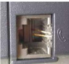
Conector RJ11 no debe confundirse con otros similares como por ejemplo, el RJ45. El RJ11 es un conector usado de forma habitual en la telefonía y que estará disponible en su PC si tiene instalado un MODEM. Puede ser que incluso disponga de dos conectores: uno destinado a recibir línea y otro a partir del cual se puede conectar un teléfono convencional.
