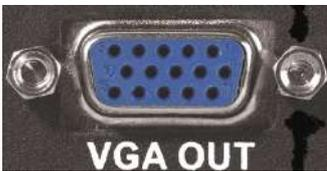
Conector de video (comúnmente llamado VGA) y está formado por 15 pines hembra distribuidos en tres filas de cinco pines cada una. A través del cable que une el monitor y la tarjeta de video mediante este conector, se establecerán las señales oportunas de color y sincronismo necesarias. Recuérdese que el video está formado por una señal de tipo analógico y no digital.
