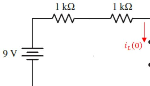
Cuando el switch se cierra nos queda en corto el lado izquierdo del circuito, quedando un circuito RL de primer orden sin fuente de voltaje, tal como se muestra en la figura.
