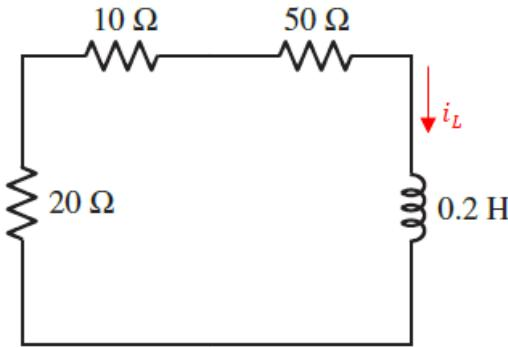
En el ejercicio 36 se da los pasos para resolver circuitos RL de primer orden sin fuentes de accionamiento. Aplicando LKV, separando variables e integrando obtenemos  $i_L$ :
