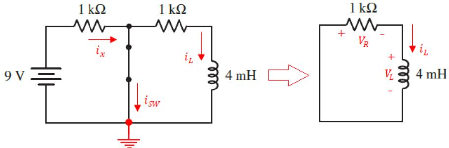
En el ejercicio 36 se da los pasos para resolver circuitos RL de primer orden sin fuentes de accionamiento. Aplicando LKV, separando variables e integrando obtenemos  $i_L$ :
