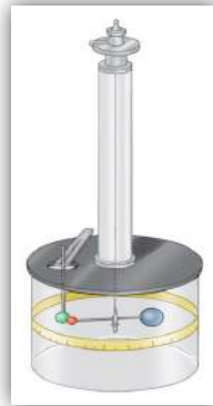
Fig.13. 3 Balanza de torsión de Coulomb, utilizada para determinar la ley del cuadrado inverso para una fuerza eléctrica entre dos cargas.
