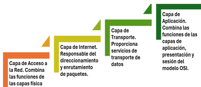
Figura 18. Capas del Modelo TCP/IP
