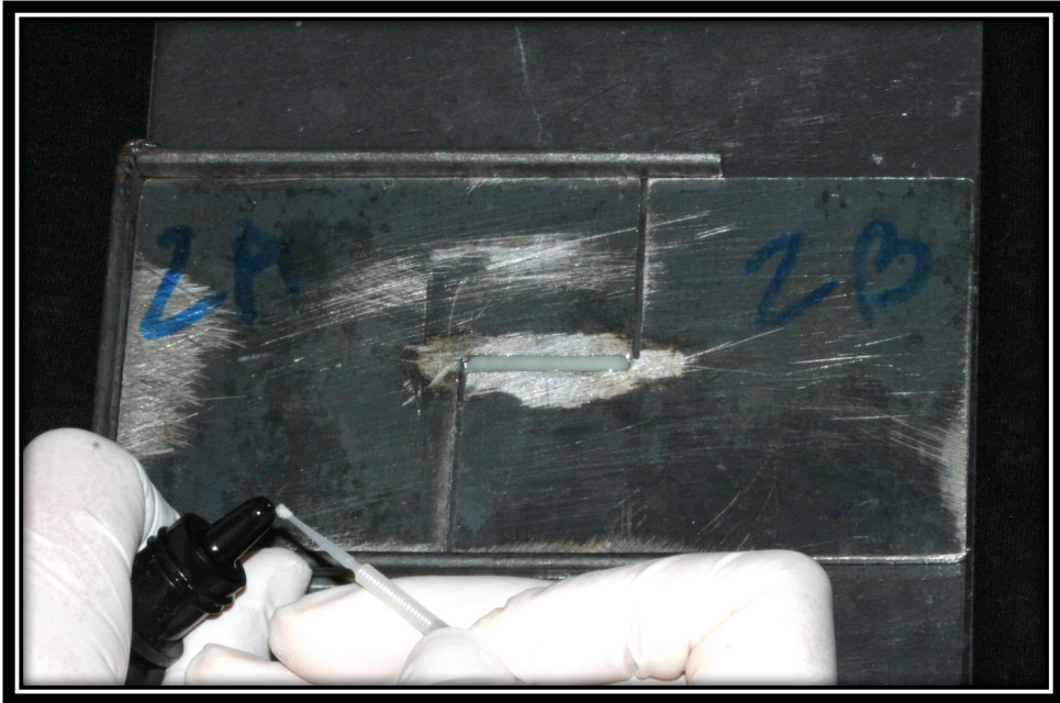
Figura No. 5 Aplicación del adhesivo bonding entre capa y capa (Fuente y Elaborador: Christel Zambrano 2013)
