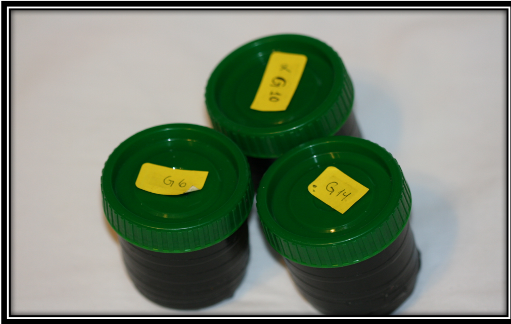
Figura No. 9 Colocación de las muestras en recipientes cerrados herméticamente oscuros(Fuente y Elaborador: Christel Zambrano 2013)
