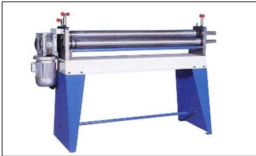
IMAGEN N° 3 ROLADORA DE CHAPA
