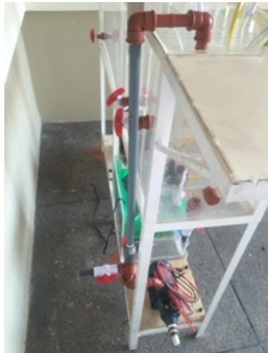
Foto 9: Vista de línea de alimentación de aa.rr. de salida de efluente
