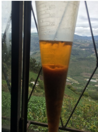
Foto 11: Vista de aa.rr. en Cono Imhoff
