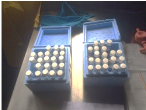
Foto 17: Vista de los viales con reactivos para pruebas de DQO
