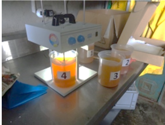
Foto 13: Vista de pruebas de tratabilidad en equipo Test de Jarras
