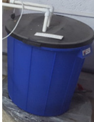
Figura 26. Tanque de PVC de 100 litros de capacidad. Fuente. (Bermeo, 2017).
