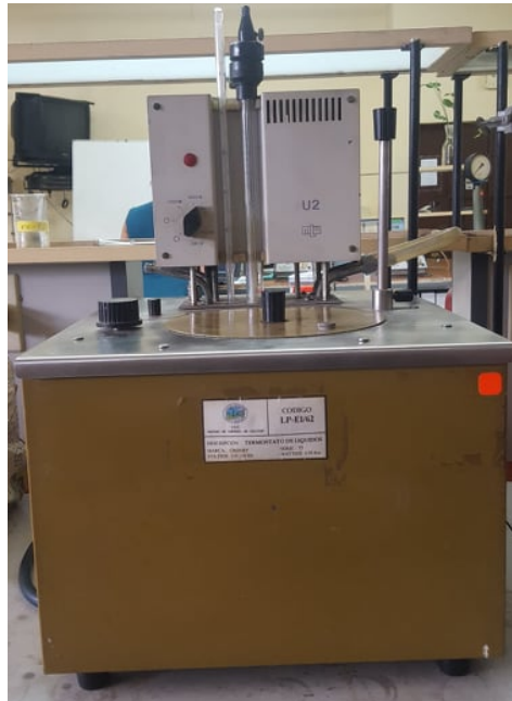
Ilustración 8 TERMOSTATO DE LÍQUIDOS equipo utilizado para Corrosión en Lámina de Cobre
