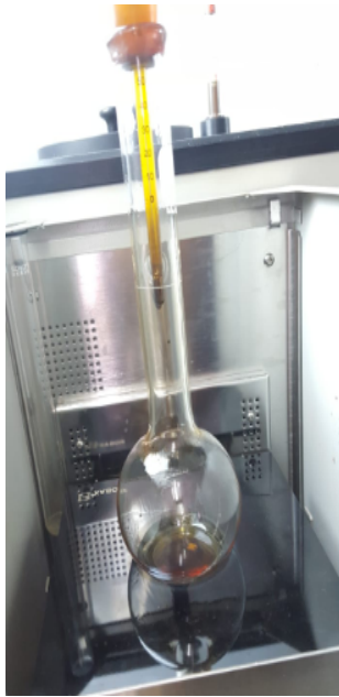
Ilustración 16 Destilación del Diésel
