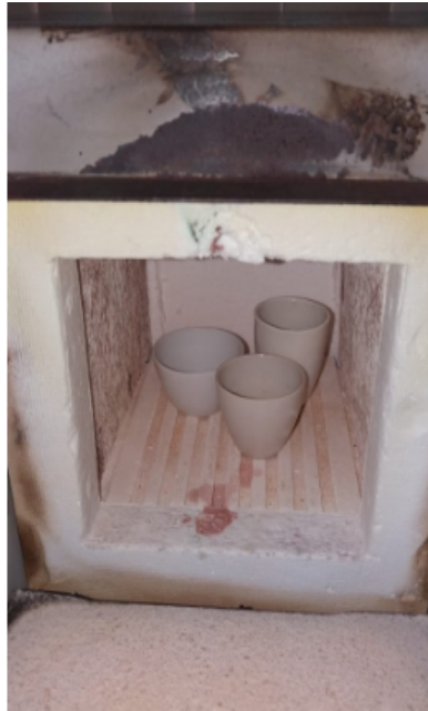
Ilustración 19 Determinación del % de ceniza que posee el Diésel
