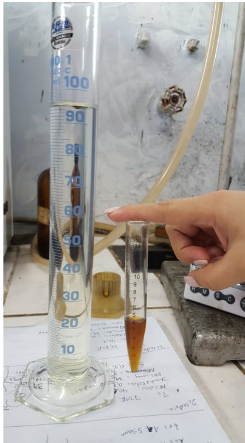
Ilustración 9 Recuperado y residuo de la primera destilación del diésel Premium
