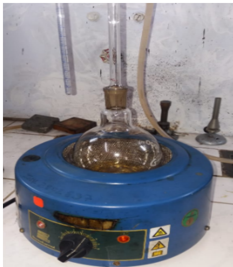
Ilustración 18 Determinación del % del contenido de agua en el Diésel
