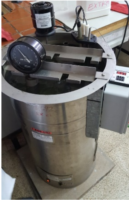
Ilustración 7 Baño de Calentamiento a 37-38°C
