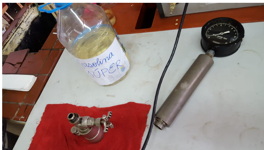
Ilustración 67 Prueba Vapor Reid para Gasolina Super.
