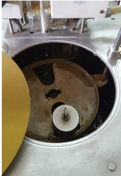
Ilustración 9 Muestra de GASOLINA SUPER dentro del TERMOSTATO DE LIQUIDOS sumergido durante 3 horas.
