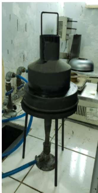
Ilustración 17 Determinación del % de Residuo Carbonoso del Diésel
