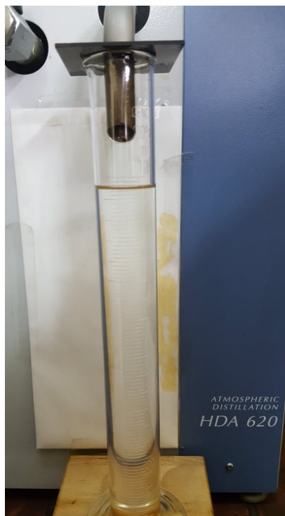
Ilustración 11 Recuperado de la segunda prueba de gasolina Súper.
