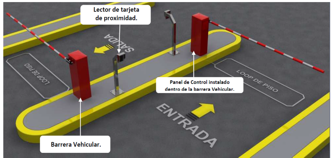
Figura 03: Control de Acceso Accionada por Tarjetas de Proximidad.
