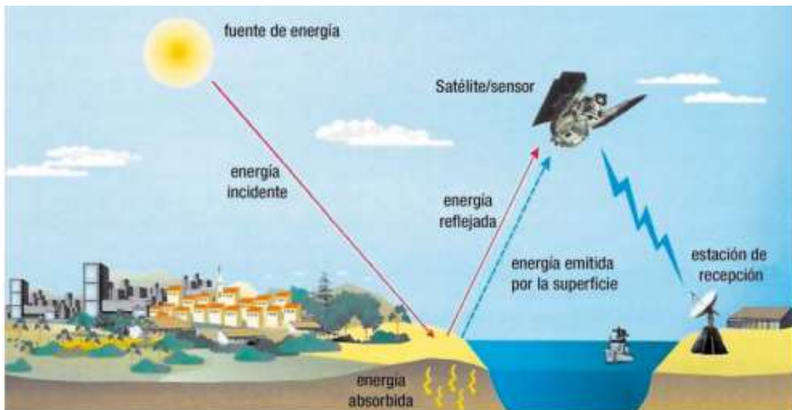
Figura 17: Elementos de la etapa de adquisición de datos por teledetección (Florenzano, 2008)
