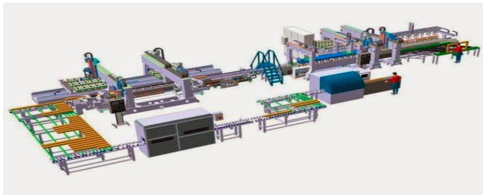
Figura 18. Esquema de forma de U producción de tarjetas electrónicas Fuente: https://www.sistemic.es/noticias/lineas-de-produccion-la-gestion-mas-eficaz-de-nuestro-sistema-productivo/
