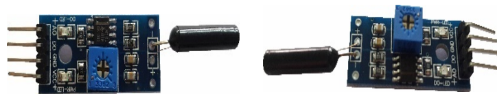
Figura 17. KY002 - Interruptor de vibración. Información tomada de la Investigación directa. Elaborada por los autores
