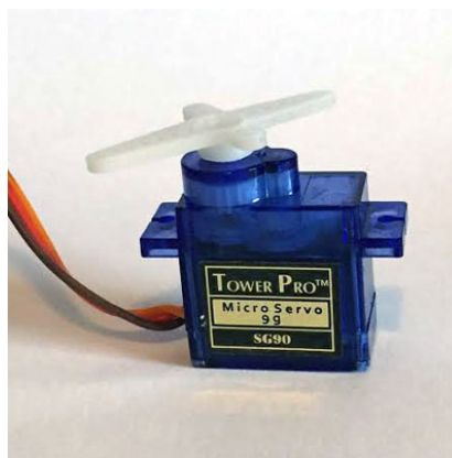
Figura 55. Servomotor 9g SG90. Información tomada de la Investigación directa. Elaborada por los autores
