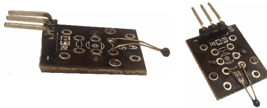
Figura 28. Sensor de temperatura. Información tomada de la Investigación directa. Elaborada por los autores
