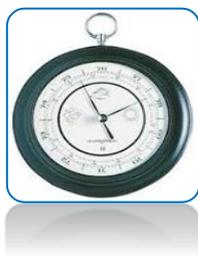
Un **barómetro metálico** es aquel formado por un recipiente de metal cuyas paredes se caracterizan por su elasticidad. La forma de este recipiente se modifica según los cambios de la presión atmosférica a partir de la extracción de aire. Dicha modificación, por su parte, se amplifica a través de una **aguja** que indica la presión que existe. El **barómetro holostérico** y el **barómetro aneróide** son otras clases de barómetros metálicos.
