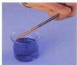
El clavo de hierro desplaza al cobre de la solución de sulfato de cobre
