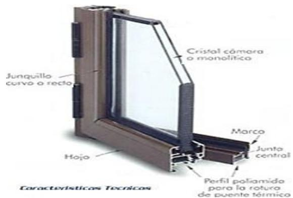
Los gases son muy malos conductores del calor; por eso, el aire contenido entre las dos hojas de las ventanas con doble acristalamiento constituye un método muy eficaz para reducir las pérdidas de calor a través de ellas.
