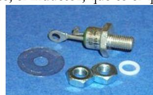
Un *rectificador*. - Transforma la corriente alterna en corriente continua, es decir, rectifica la corriente alterna.
