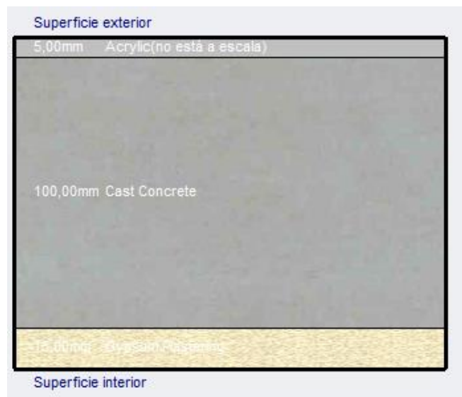
Ilustración 40. Detalle de los componentes constructivos del muro. Fuente: elaboración propia mediante programa DesignBuilder.
