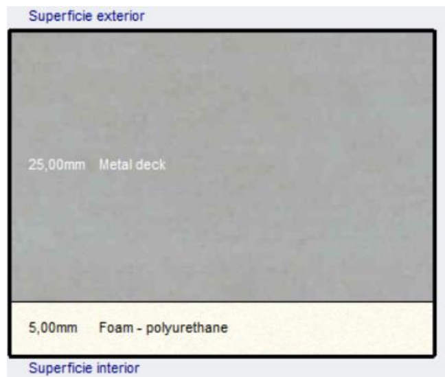
Ilustración 43. Composición constructiva de la cubierta. Fuente: elaboración propia mediante programa DesignBuilder.
