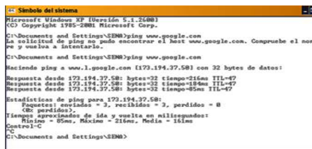
Figura 48. Firewall. Realización del Ping
