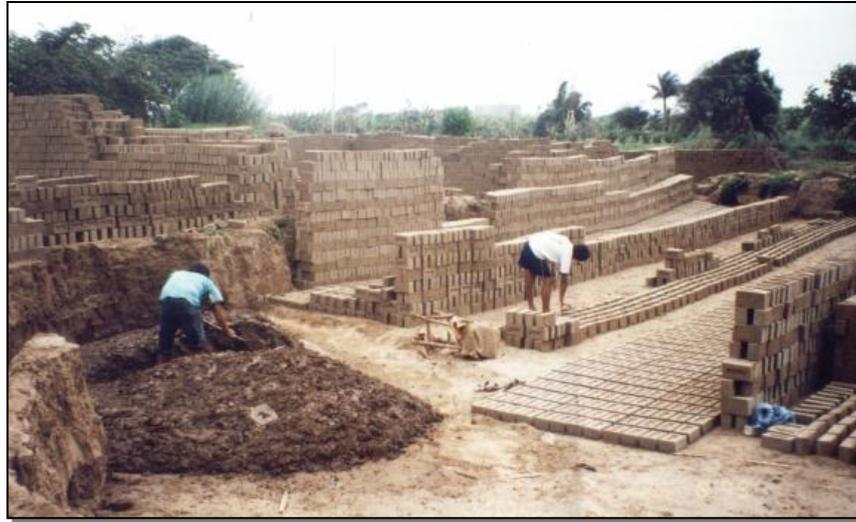
**Fotografía N° 02. Vistas de la Fabricación de ladrillos.**
