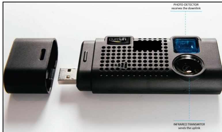
Figura 17. Dongle USB pureLiFi con sus respectivos componentes
