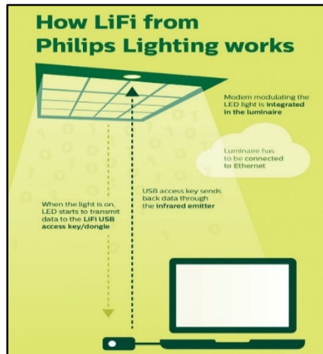
Figura 11. Ilustración de cómo funciona Lifi de Philips
