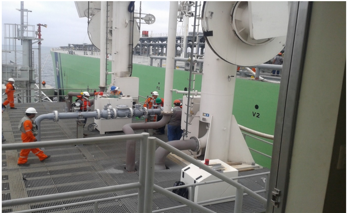
Ilustración 186.- maniobra de conexión de brazos de carga y descarga entre el terminal marítimo y el bw liberty
