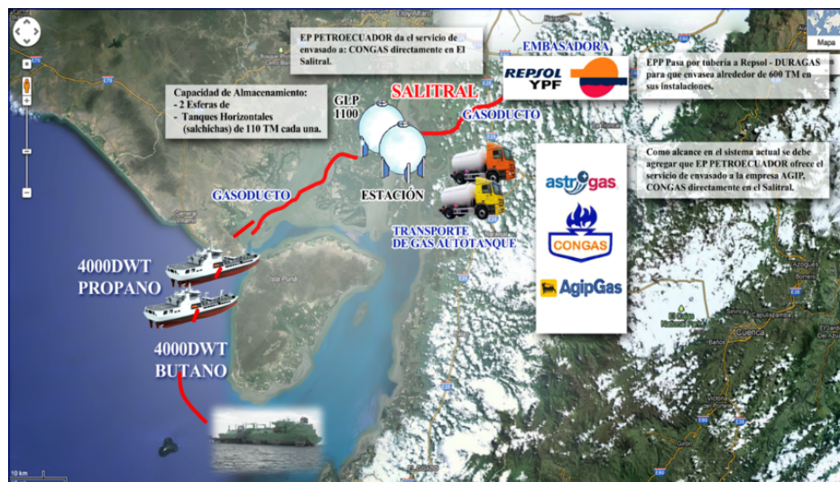
Ilustración 3.- antiguo sistema de almacenamiento flotante para la provisión de GLP
