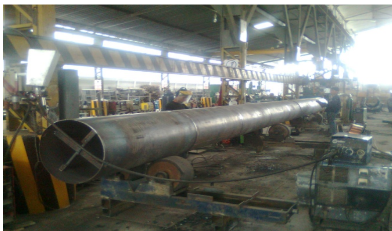
Ilustración 97.- soldadura de tubos para conformación de los pilotes del muelle provisional
