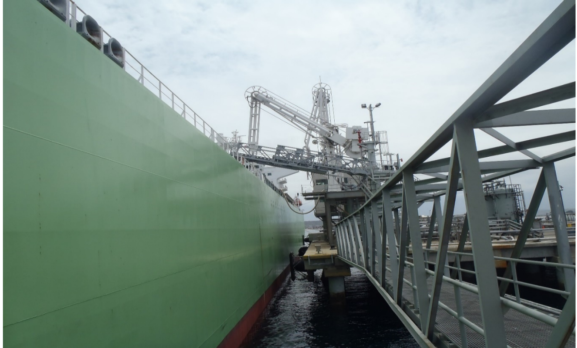
Ilustración 186.- maniobra de conexión de brazos de carga y descarga entre el terminal marítimo y el bw liberty
