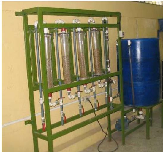
Figura 21. Columnas de Neutralización con lecho de caliza Flujo ascendente.
