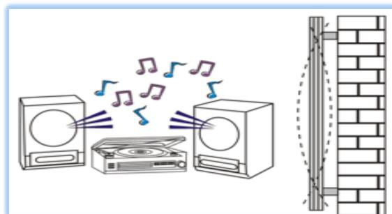
**Gráfico No.8: Esquema de un absorbedor acústico de membrana.**
