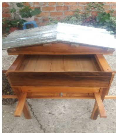
Figura 3. Construcción de prototipo de corrediza para el secado de cacao
