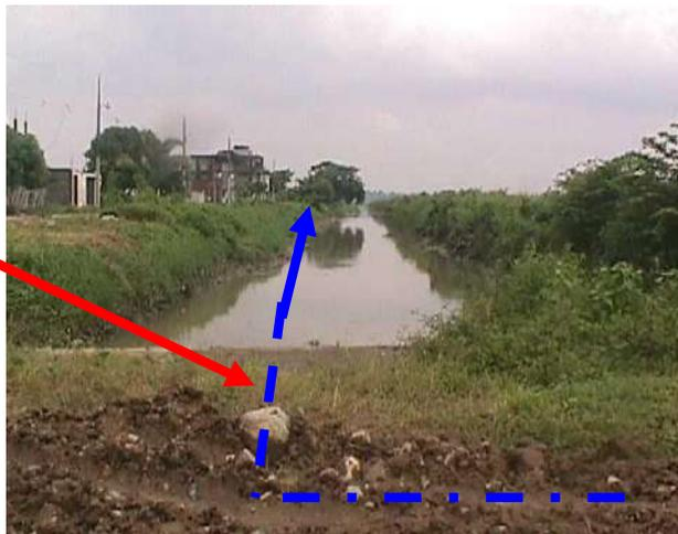
Figura 132.- Canal principal de la cuenca al momento que llega al lado oeste de la ciudadela Las Orquídeas, recibe en ángulo de 90 grados el caudal que viene de la cuenca alta por medio del drenaje de la Av. Isidro Ayora.- Fuente: Autor
