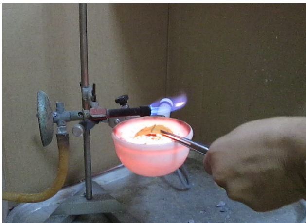
Figura 1. Montaje del ensayo de inflamabilidad
