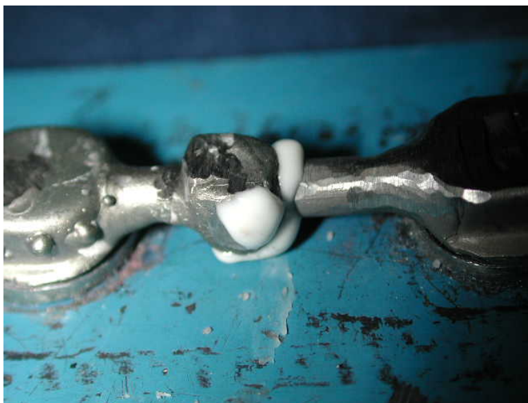
Fig. 40 Cubrimiento de pasador con cemento
