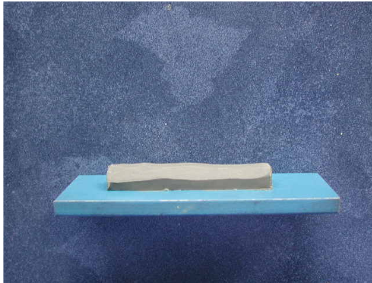
Fig. 8 Platina estándar con separación de plastilina.
