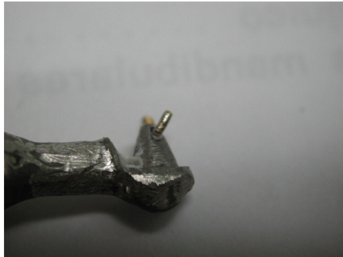
Fig. 60 Pasador deformado patriz intacta.
