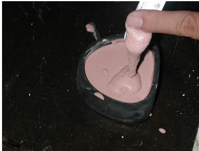
Fíg. 21 Colocación de revestimiento sobre base para soldar
