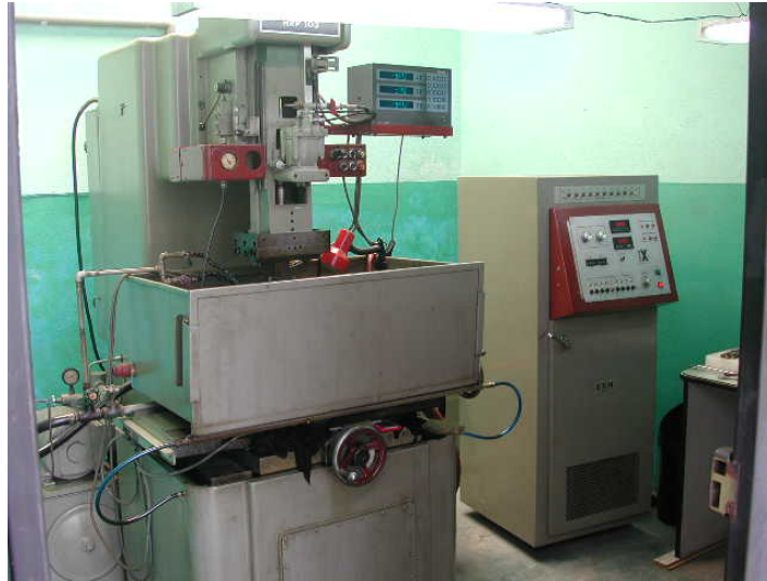
Fig.34 Máquina de electroerosión Industrial ELOX HRP 103
