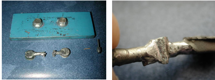
Fig.44 Atache rielera modificado con platina estándar.
