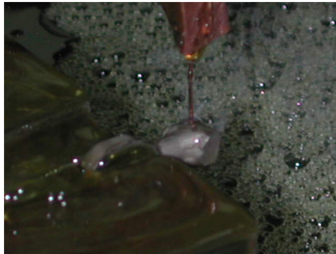
Fig. 35 Perforación de patriz por electroerosión
