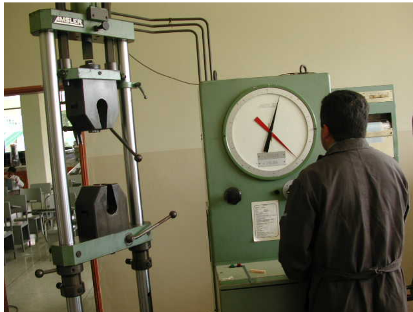
Fig. 5 Máquina de ensayos universales (Laboratorio de pruebas de materiales Escuela Politécnica del Ejército).
