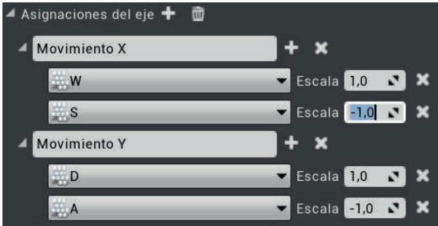
Para el movimiento con el mouse asignamos la vista X, para el plano del cursor del mouse X con escala 1.0 y la vista Y para el cursor del mouse Y con escala -1.0. Cerramos la ventana y el proceso se guardará automáticamente.
