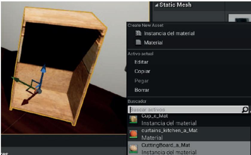
Para Drawer debemos seleccionarla y situarnos en las configuraciones "Material Settings" agregamos un nuevo array elements.
