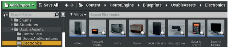
Agregar el Asset Security Control luego lo seleccionamos y nos dirigimos a las configuraciones. Dentro de Password podemos ingresar la contraseña en dígitos numéricos, y también podemos configurar una alarma después de una cantidad de intentos fallidos además de la duración del sonido.
