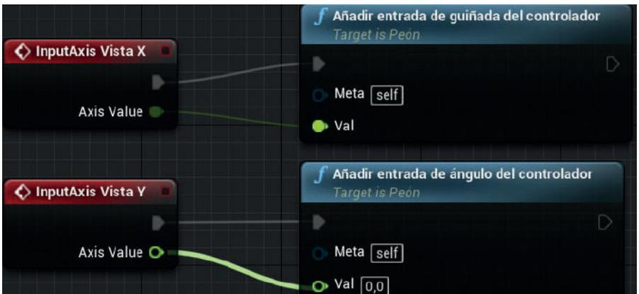
En ambos nodos de movimiento del mouse, conectamos los Axis value con la acción "Val", compilamos.
