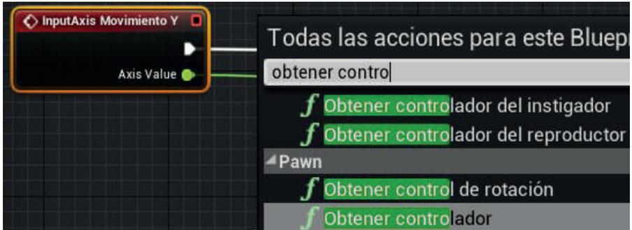
Inmediatamente dentro del nodo "Obtener control de rotación seleccionamos Obtener vector derecho".
