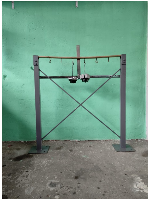
Figura 20. Equipo para investigar deformación y estabilidad en vigas
