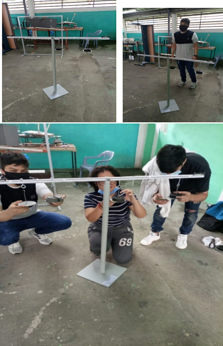
Figura 13. Equipo para comportamiento estructural en el edificio por momento flector
