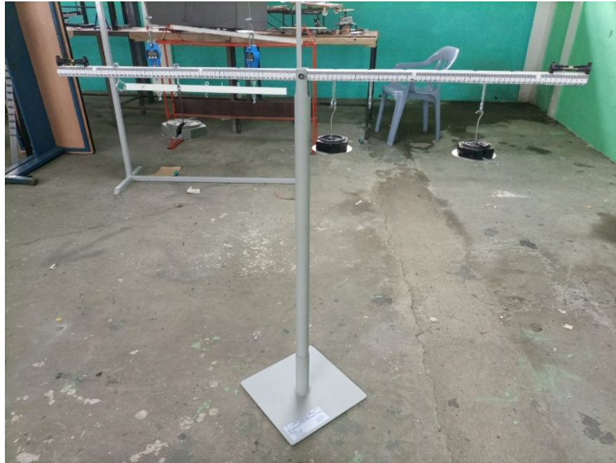
Figura 18. Equipo para investigar el momento flector en vigas para edificios
