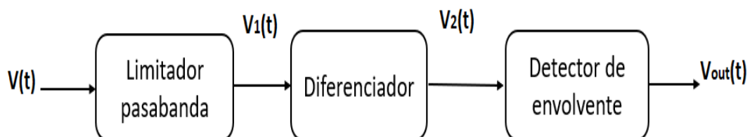
Figura 1. 29: Demodulación en frecuencia utilizando detección de pendiente.
