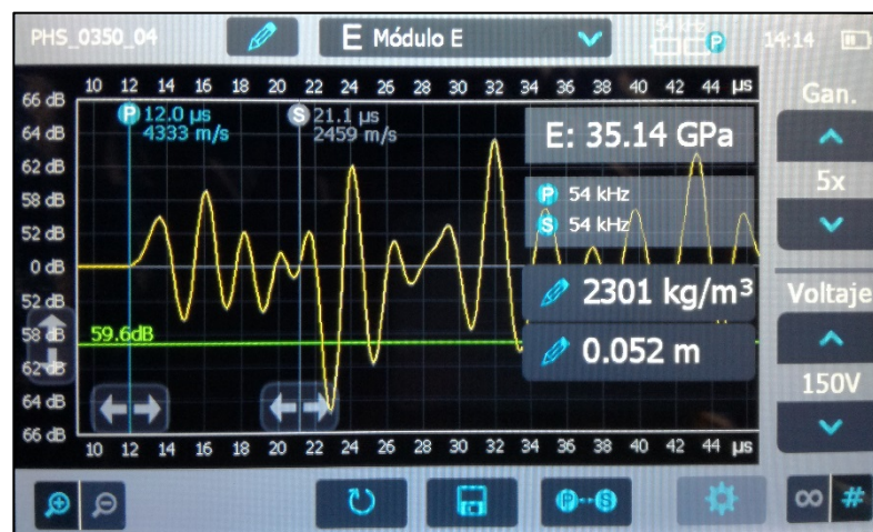
Figura 40. Pantalla Equipo Pundit PL-200, Determinación del Módulo de Elasticidad
