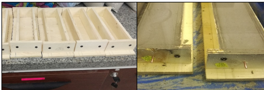
Figura 22. Preparación de los moldes.
