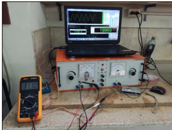
Figura 29. Equipo de medición de resistividad eléctrica con C.A.
