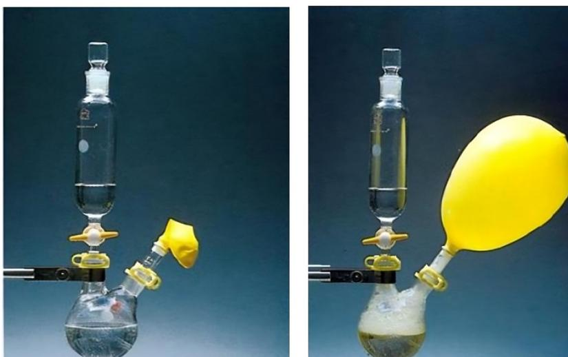
Fig. 2.13 Descomposición de  $\text{H}_2\text{O}_2$
